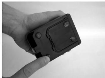
**D** Den Batteriefachdeckel abnehmen und 4 Batterien (Typ AA) zu 1,5 Volt (nicht geliefert) einsetzen. Wird der Adapter benutzt, vor dem Anschluss Spannung und Polarität überprüfen.
